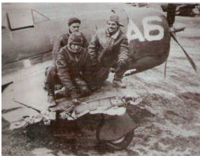
P-47 gravemente danneggiato dalla contraerea
